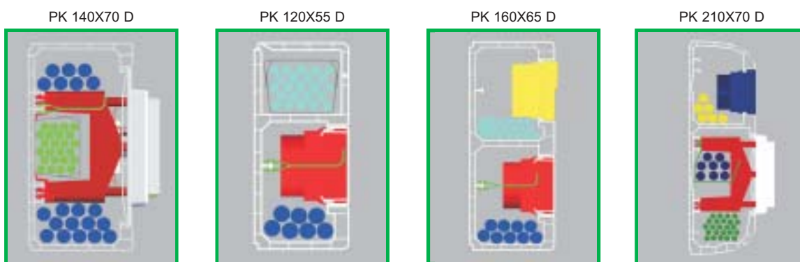
Парапетный канал PK 120X55 D с вложенным экранирующим каналом, установленными приборами и перегородкой
